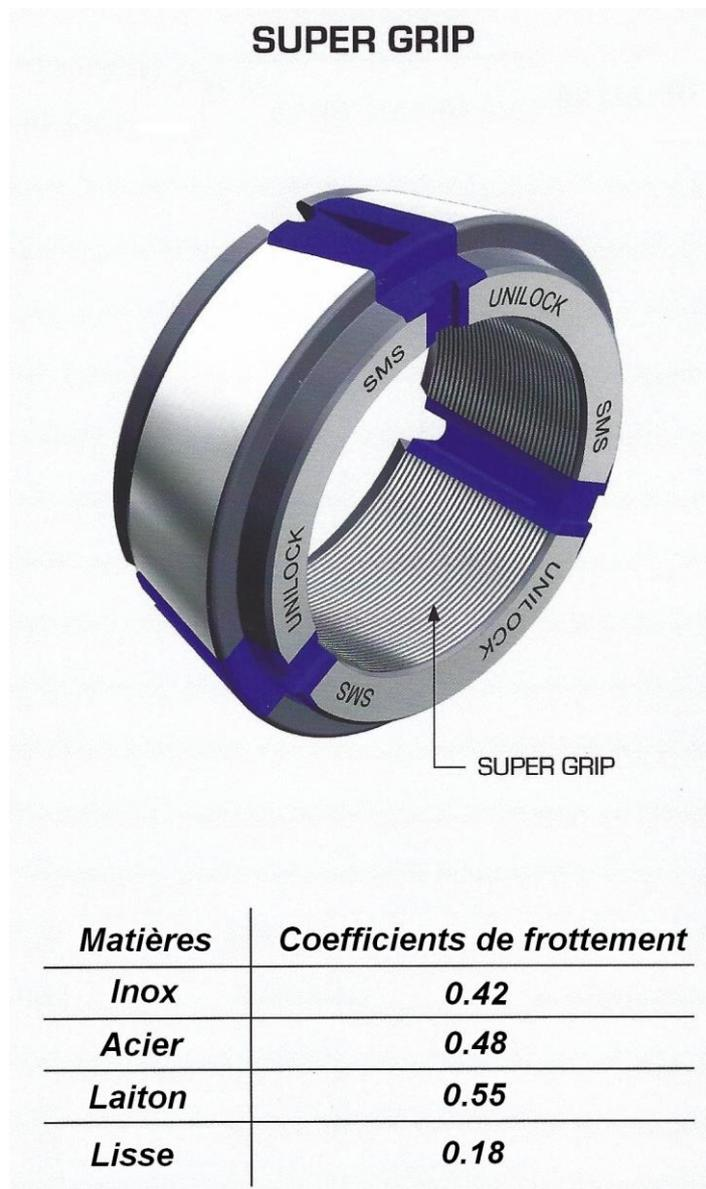
En plus des caractéristiques de base de la pince SMS, la pince Unilock **SUPER-GRIP** présente sur ses mors une rugosité obtenue par usinage à haut coefficient de frottement qui augmente encore la force de serrage.
